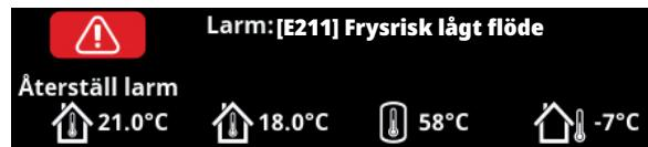
De kritiska larmen [E135], [E211], [E216] och [E217] kan kvitteras vardera tre gånger med kod 4005. Efter fyra larm blockeras värmepumpen.
